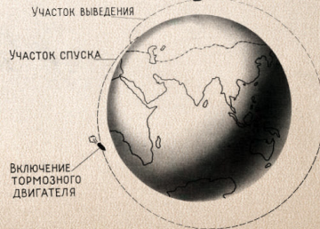
СХЕМА ПОЛЁТА КОРАБЛЯ-СПУТНИКА «ВОСТОК»
