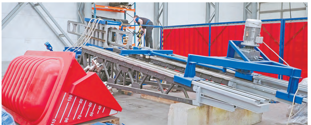
Линейный генератор, преобразующий энергию волн в источник питания.
